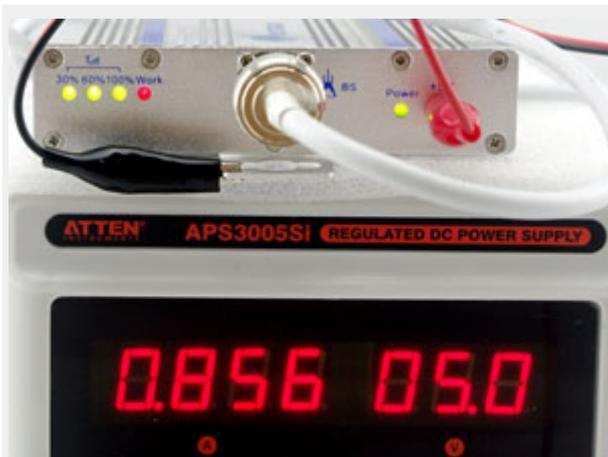
采用 5V 中的低功耗的器件. 如左图上下行同时工作:  $5.0V \times 0.86A = 4.3W$
